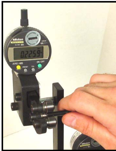
Tri-roll Gage indicating actual thread size of 1/4-28 3A part.
